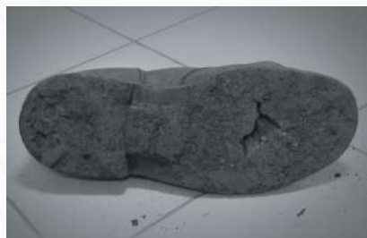
Подошва разрушилась от контакта с нагретой поверхностью
